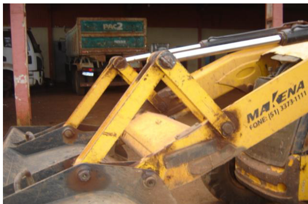
H da concha dianteira com reforços e soldas
